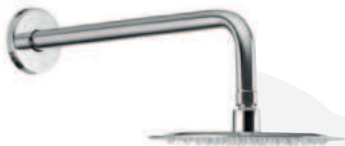
Kit doccia composto da: braccio doccia serie ROLL in ottone Ø 250 mm, lunghezza 350 mm + soffione getto anticalcare serie WARRIOR-R in acciaio, con supportoserie EGO in ottone, flessibile SILVER doccia da ½" x ½" effetto cromo antitorsione 150 cm SOFFIONE Ø200 mm.
